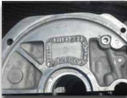
WELD BEHIND #3 Refuerza Atras del #3
