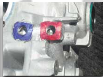
DUAL FULL FLOW Salida Y Retorno Doble De Aceite
